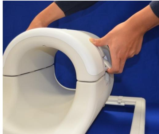
9. Setzen Sie die 18ch T/R-Kniespule - Unterlage, 1,27 cm (5561409-8) und das große zylindrische vereinheitlichte Phantom, SiOil (5342679-2), auf die Spule, wie unten dargestellt.
