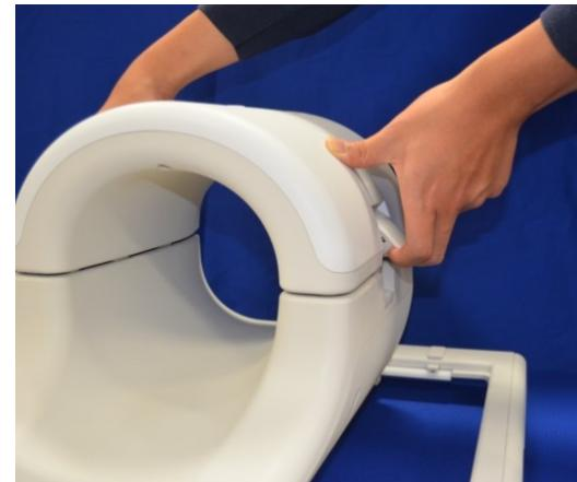
9. Τοποθετήστε το πηνίο γόνατος 18ch T/R - Κάτω μαξιλαράκι, 0,5" (5561409-8) και το μεγάλο κυλινδρικό ενοποιημένο ομοίωμα, SiOil (5342679-2) πάνω στο πηνίο όπως απεικονίζεται παρακάτω.
