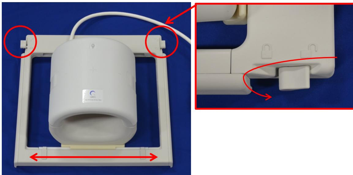
8. Séparez la moitié supérieure de l'antenne en tirant simultanément sur les deux languettes de fixation jusqu'à ce que les deux moitiés soient entièrement désengagées.
