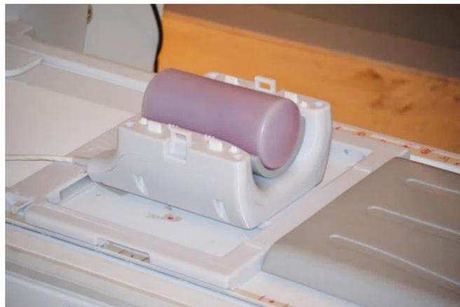
10. Remettez en place la moitié supérieure de l'antenne. **Vérifiez que les deux moitiés sont entièrement fermées et que les languettes de fixation sont rabattues vers l'intérieur.**
