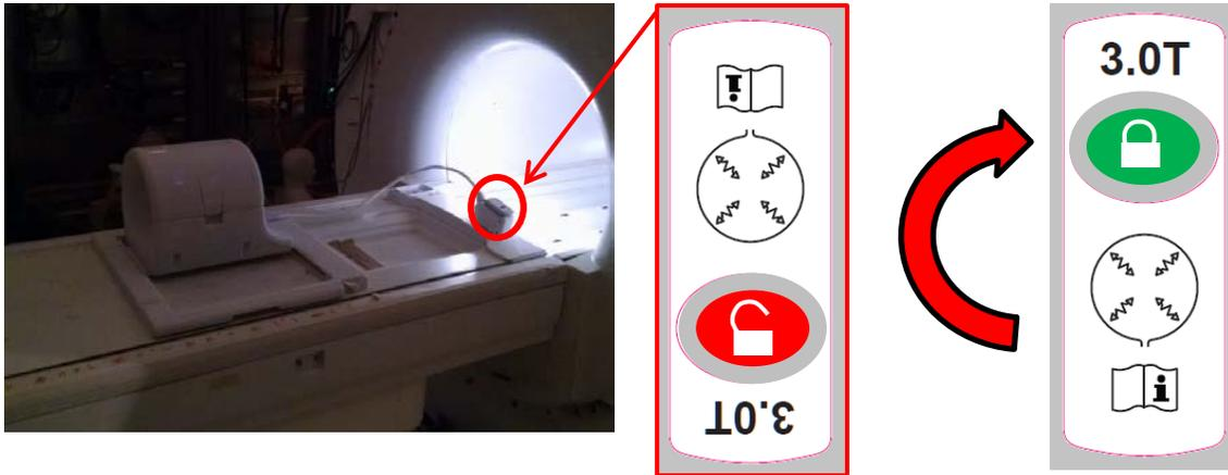
5. Ajustez l'antenne vers la gauche/droite pour améliorer le confort du patient. Si des réglages sont nécessaires, tournez la molette sur le cadre de l'antenne pour la déverrouiller et la faire glisser dans la position voulue.
