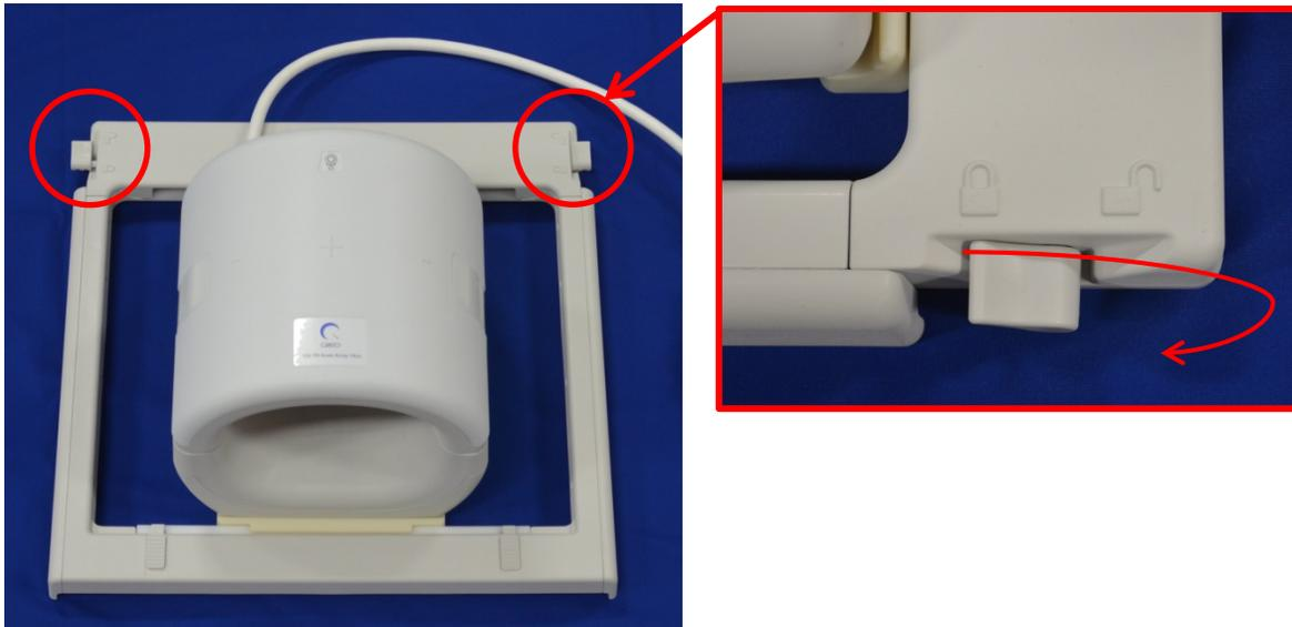
7. Une fois l'antenne positionnée correctement, tournez de nouveau la molette pour la verrouiller en place.
