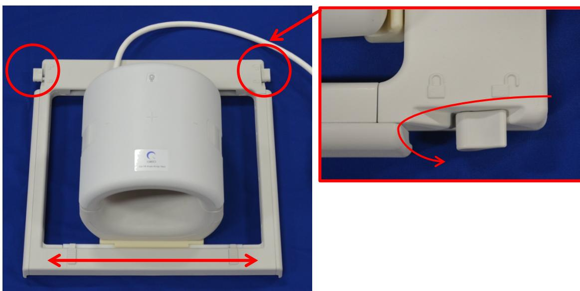
7. Odvojte prednji kalem istovremenim povlačenjem oba krilca preklopne brave dok se dve polovine u potpunosti ne odvoje.
