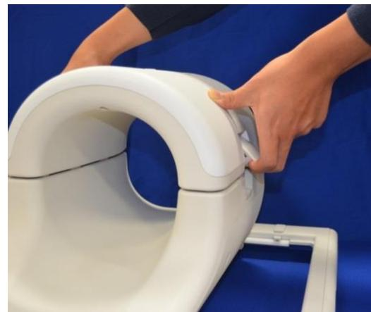
9. Aşağıda gösterilen şekilde, 18ch T/R Diz Koili - Alt Ped, 0,5 inch (5561409-8) ve Büyük Silindirik Birleşik Fantom, SiOil'i (5342679-2) koilin üzerine yerleştirin.
