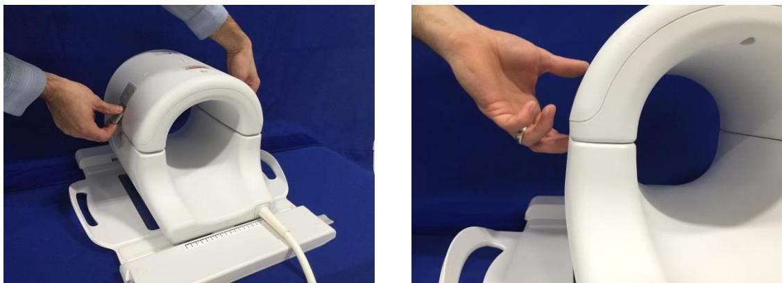
9. Τοποθετήστε το πηνίο γόνατος 18ch T/R - Κάτω μαξιλαράκι, 0,5" (5561409-8) και το μεγάλο κυλινδρικό ενοποιημένο ομοίωμα, SiOil (5342679-2) πάνω στο πηνίο όπως απεικονίζεται παρακάτω.
