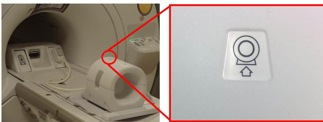
5. Συνδέστε το βύσμα του πηνίου στην κατάλληλη θύρα εκπομπής του συστήματος. (Ανατρέξτε στο Παράρτημα – Θέση θύρας TR) Γυρίστε το άκρο του βύσματος της θύρας P ώστε να εμφανίζει τη θέση ΚΛΕΙΔΩΜΕΝΟ, βλ. εικόνα δεξιά.
