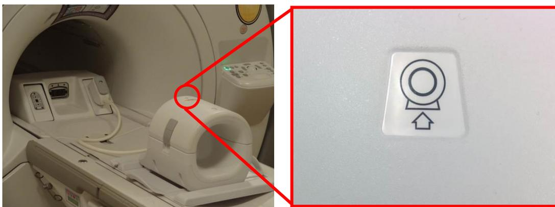
5. Conecte el conector de la bobina al puerto de transmisión correcto del sistema. (Consulte el Apéndice: Ubicación del puerto de T/R). Dele la vuelta al extremo del conector del puerto P de modo que se vea la posición de BLOQUEO; fíjese en la ilustración de la derecha.
