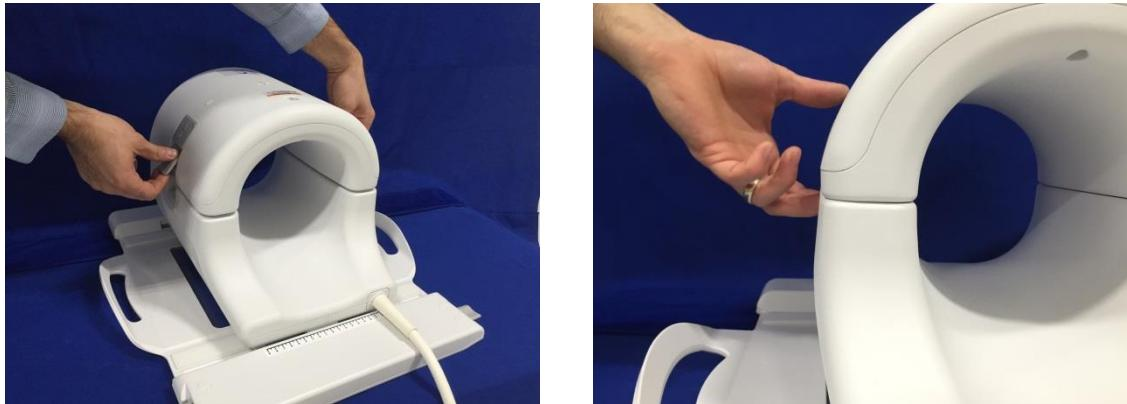
9. Na zavojnicu postavite 18ch T/R zavojnicu za koljeno - donji podložak, 0,5" (5561409-8) i veliki cilindrični unificirani fantom, SiOil (5342679-2), kako je prikazano u nastavku.
