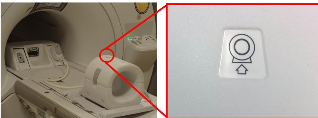
4. Collegare il connettore della bobina alla porta di trasmissione appropriata del sistema (vedere l'appendice "Posizione della porta di TR"). Ruotare l'estremità del connettore della porta P in posizione BLOCCATA; vedere l'immagine a destra.
