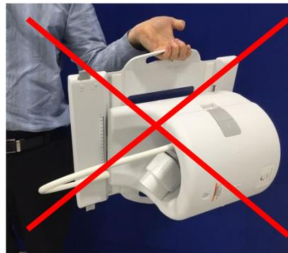
4. Mettere la bobina sul tavolo radiologico. Si osservi che la freccia che indica la direzione della camera cilindrica illustrata sotto deve puntare **verso** la camera cilindrica.
