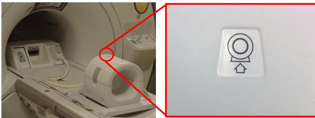
5. Шарғы қосқышын жүйенің тиісті Тасымалдау үясына жалғаныз. (Қараңыз: Қосымша – ТК үясының орны) Р үясы қосқышының шетін бұрап, БЕКІТУЛІ күйге келтіріңіз; он жақтағы суретті қараңыз.
