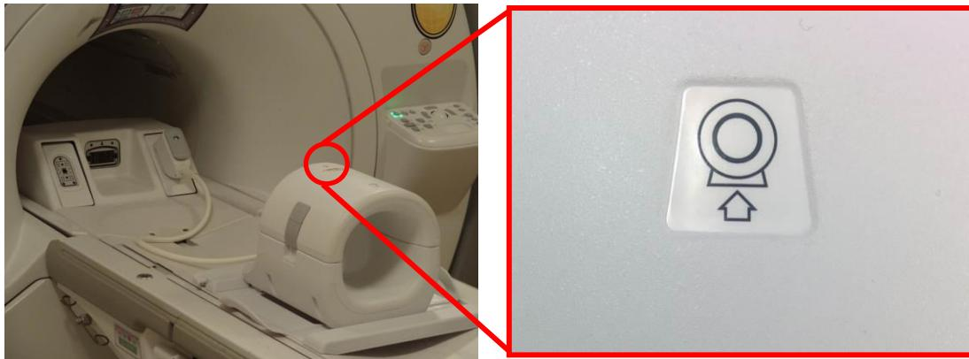
5. Koble spolekontakten til riktig Overføringsport på systemet. (Se Vedlegg TR-portens beliggenhet) Snu enden av P-portens tilkobpling rundt slik at den viser stillingen LOCKED (låst), se bildet til høyre.
