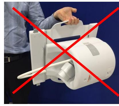
4. Sett spolen på pasientstativet. Vær oppmerksom på at hullets pilretning som vist nedenfor skal peke **mot** hullet.
