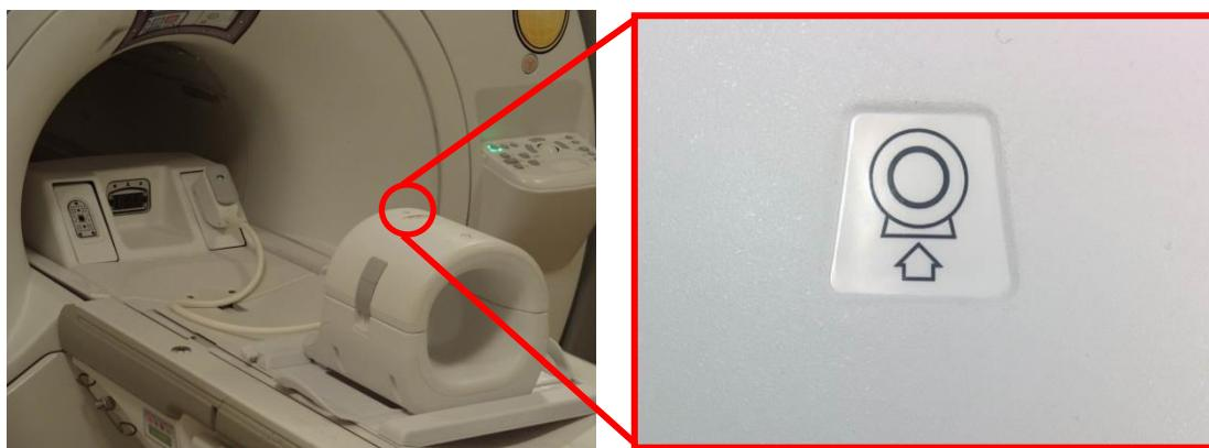
4. Koble spolekontakten til riktig Overføringsport på systemet. (Se Vedlegg TR-portens beliggenhet) Snu enden av P-portens tilkoppling rundt slik at den viser stillingen LOCKED (låst), se bildet til høyre.
