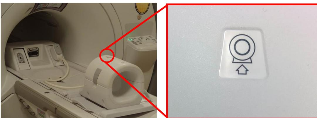
4. Pripojte konektor cievky do vhodného portu prenosu systému. (Pozrite si prílohu „Umiestnenie portu TR) Otočte koniec konektora P-Port tak, aby sa nachádzal v polohe UZAMKNUTÝ, pozrite si obrázok vpravo.
