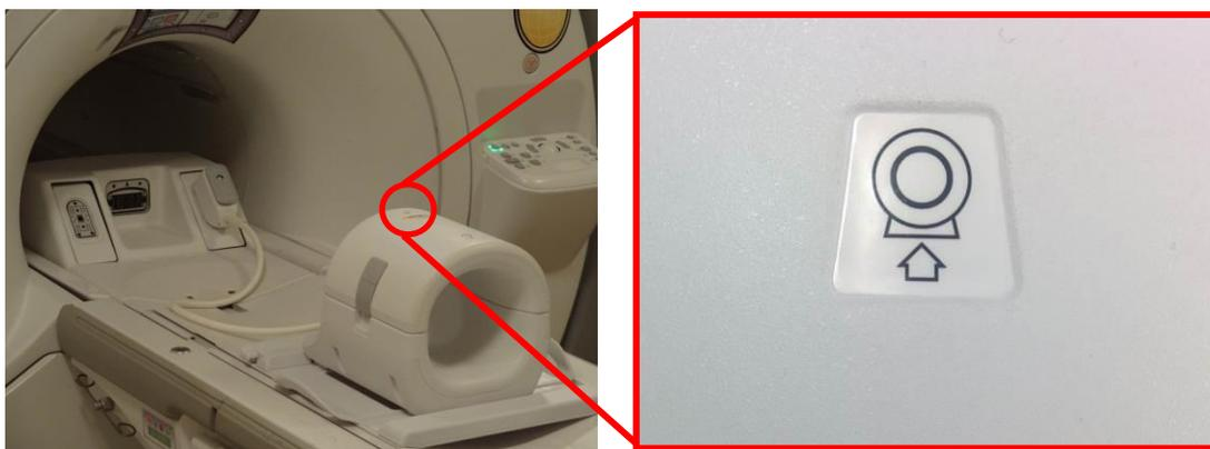
5. Pripojte konektor cievky do vhodného portu prenosu systému. (Pozrite si prílohu „Umiestnenie portu TR“) Otočte koniec konektora P-Port tak, aby sa nachádzal v polohe **UZAMKNUTÝ**, pozrite si obrázok vpravo.
