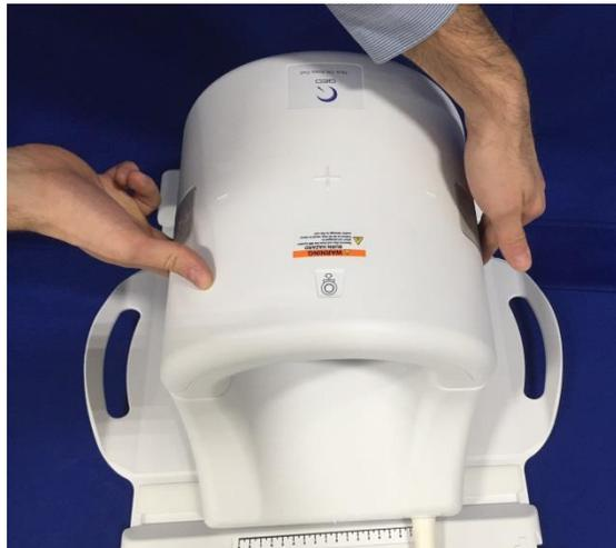
4. Kada se spoljni deo u potpunosti zatvori, pritisnite krilca preklopne brave sa obe strane ka površini kalema da bi se u potpunosti zabravila preklopna brava. U slučaju da se preklopna brava ne zabravi u potpunosti, kalem može da se isključi tokom skeniranja i da dođe do potpunog ili naizmeničnog prekida konekcije između dve polovine, što kao posledicu može imati loš kvalitet slike ili oštećenje kalema.
