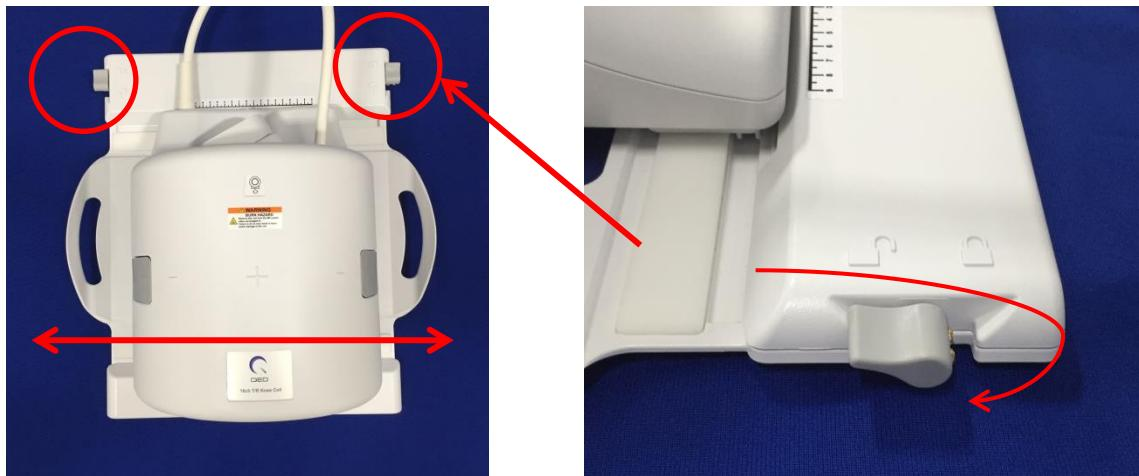
7. 同时拉动两片闩锁舌片以分离之前所述的线圈，直到两个半节完全分离。
