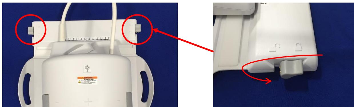
7. 线圈到达所需位置后，再次旋转旋钮以锁定位置，将线圈固定。
