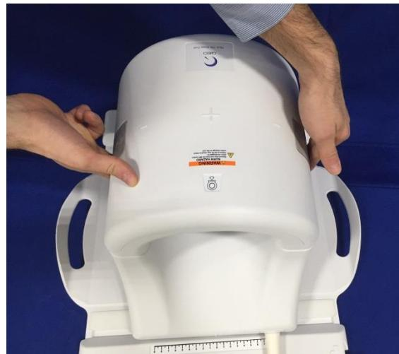
4. 后半节线圈完全关闭后，沿线圈表面向下推动两侧的闩锁舌片，可完全卡紧机械栓锁。如果闩锁未完全卡紧，线圈可能会在扫描期间断开并造成两个半节线圈之间的连接全部丢失或间歇相连，进而导致成像质量较差或损坏线圈。
