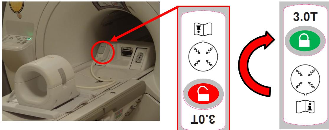
5. 确保线圈在左右方向上处于架子的中心位置。如果需要调整，应旋转线圈架上的旋钮以解锁线圈，然后将其滑动到所需位置。
