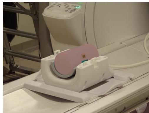
10. 重新连接之前的半节线圈。确保两个半节完全闭合，然后推入闩锁舌片。
