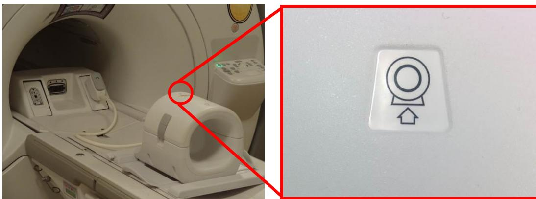
5. 将线圈连接器连接到系统相应的发射端口。（参阅附录 - TR 端口位置）转动 P 端口连接器的末端，使其呈现出“锁定”位置，参见右侧图片。
