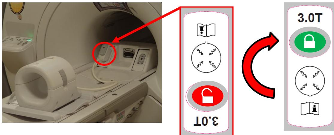
6. 确保线圈在左右方向上处于架子的中心位置。如果需要调整，应旋转线圈架上的旋钮以解锁线圈，然后将其滑动到所需位置。
