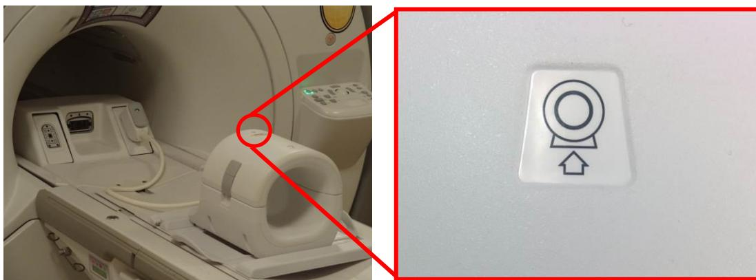
4. 将线圈连接器连接到系统相应的发射端口。（参阅附录 - TR 端口位置）转动 P 端口连接器的末端，使其呈现出“锁定”位置，参见右侧图片。
