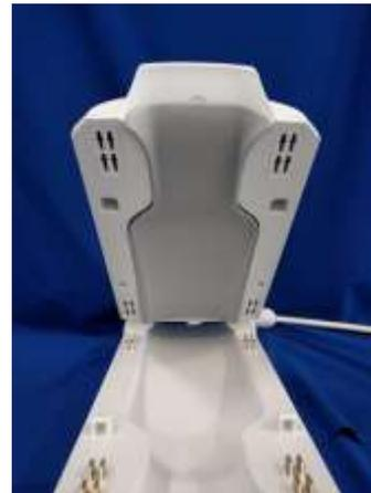
10. Τοποθετήστε το ενοποιημένο κυβικό ομοίωμα μέσα στο πηνίο όπως απεικονίζεται παρακάτω. **Βεβαιωθείτε ότι η κάτω πλευρά του ομοιώματος ευθυγραμμίζεται με τις ενδείξεις οπτικού πεδίου στο πηνίο.**
