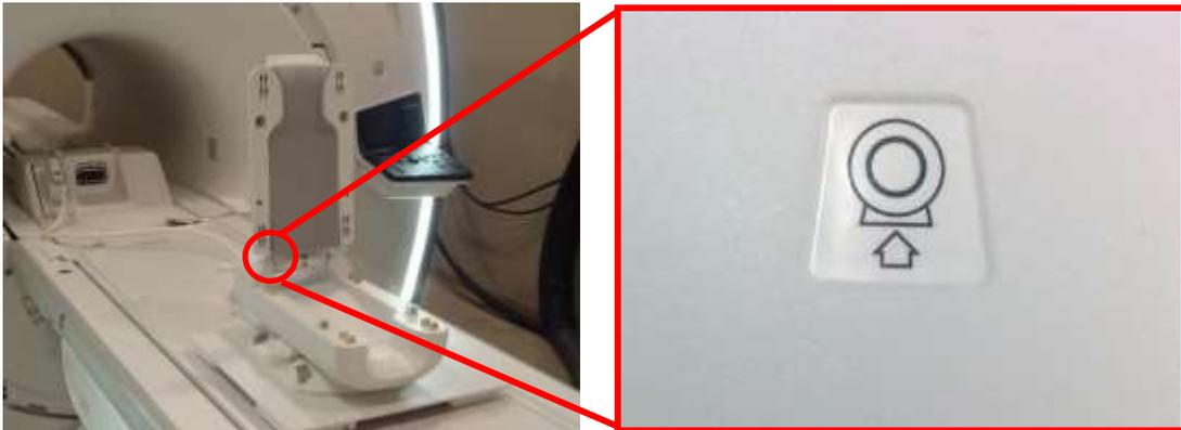
5. Συνδέστε το βύσμα του πηνίου στην κατάλληλη θύρα εκπομπής του συστήματος. (Ανατρέξτε στο εγχειρίδιο χρήσης του συστήματος για τη θέση της θύρας TR) Γυρίστε το άκρο του βύσματος της θύρας P ώστε να εμφανίζει τη θέση ΚΛΕΙΔΩΜΕΝΟ, βλ. εικόνα δεξιά.
