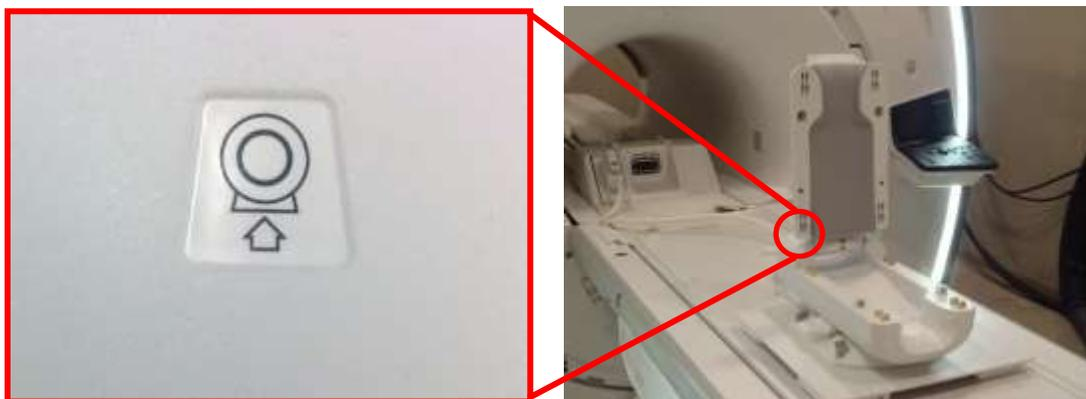
4. Подключите штекер катушки к соответствующему разъему для передачи данных на системе. (Расположение разъема приема/передачи указано в руководстве пользователя системы). Переверните конец разъема P-Port так, чтобы он соответствовал ЗАФИКСИРОВАННОМУ положению, как показано на рисунке справа.
