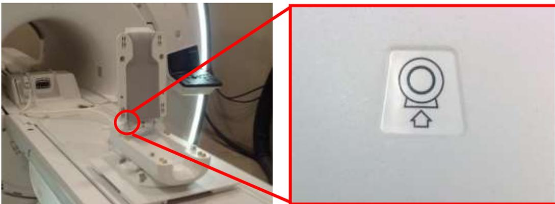
5. Подключите штекер катушки к соответствующему разъему для передачи данных на системе. (Расположение разъема приема/передачи указано в руководстве пользователя системы). Переверните конец разъема P-Port так, чтобы он соответствовал **ЗАФИКСИРОВАННОМУ** положению, как показано на рисунке справа.
