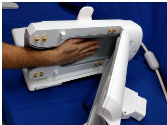
Pour changer de base, tenez l'antenne en poussant fermement sur le levier de déblocage de l'antenne, présenté sur les bases correspondantes ci-dessous :
