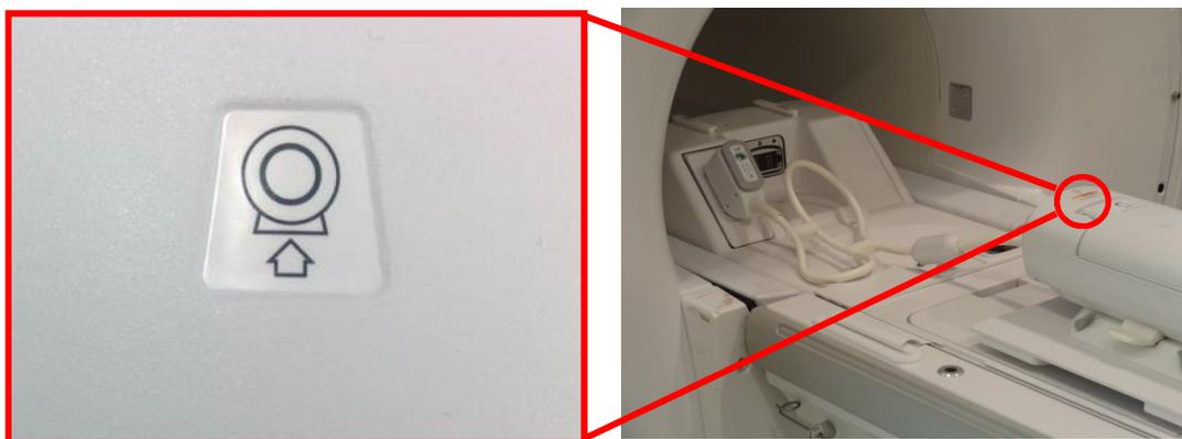
4. Pour éviter les boucles et le contact avec le patient, acheminez le câble excédentaire en utilisant les clips de passage de câble fixés au système comme indiqué ci-dessous.
