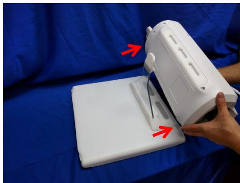
Installez ensuite la base voulue en alignant et en verrouillant l'antenne dans la base, comme indiqué ci-dessous.
