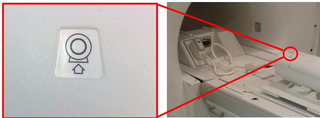
4. Kako ne bi došlo do zapetljanja i dodira s pacijentom, višak kabela usmjerite pomoću vodilica na kabelu sustava, kako je prikazano u nastavku.
