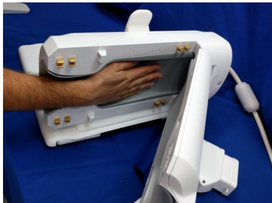
Para trocar as bases, enquanto segura a bobina, empurre firmemente na alavanca de liberação da bobina, mostrada nas bases respectivas abaixo:
