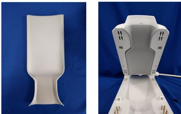
10. Coloque o fantasma cúbico unificado (5342681) na bobina, como mostrado abaixo. **Garanta que a borda inferior do fantasma esteja alinhada com as marcações FOV na bobina.**
