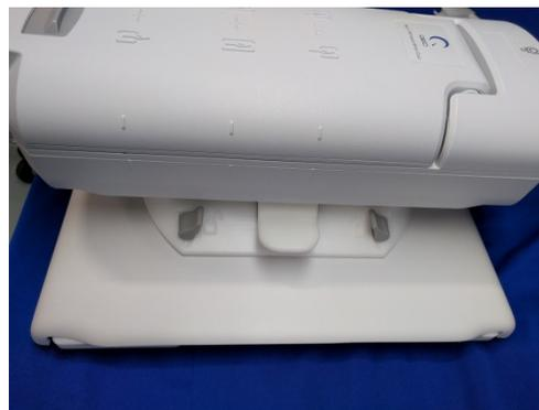
8. Abra a bobina deslizando a trava para frente e puxando para cima, na posição anterior.
