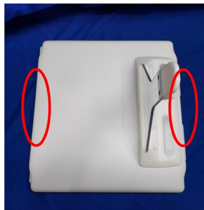
4. Postavite kalem za koleno na ram za pacijenta. Obratite pažnju da strelica za pravac tunela koja je prikazana ispod treba da bude okrenuta **ka** tunelu.
