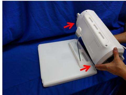
Zatim montirajte željenu osnovu poravnavanjem i zaključavanjem kalema na osnovu, kao što je ispod prikazano.
