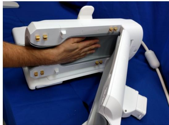
如需切换底座，握住线圈同时稳稳地推动线圈释放杆，如下方相应的底座所示：
