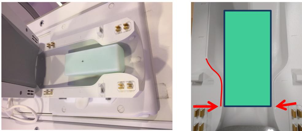
11. 关闭线圈，确保前部门锁释放卡入到位。
