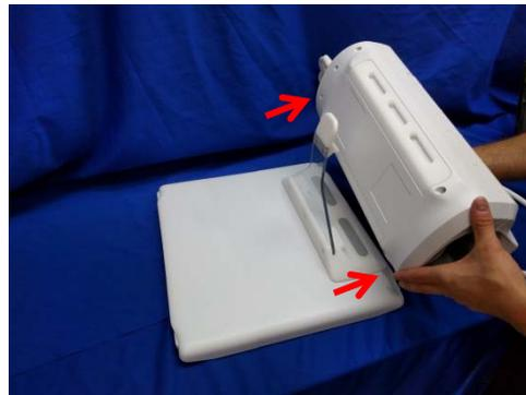
随后，通过对齐线圈并将其锁定到底座中来安装所需的底座，如下所示。
