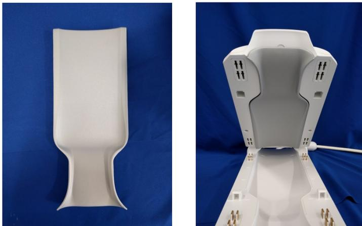
10. 将统一立方模体 (5342681) 放入线圈中，如下所示。确保模体的底边与线圈上的 FOV 标记对齐。
