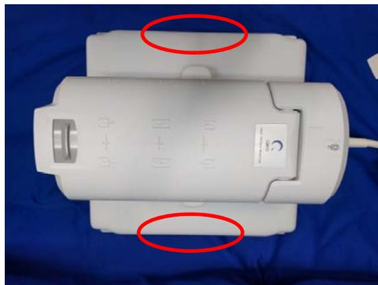
3. 将线圈放在患者支架上。请注意，下图绘制的空腔方向箭头应指向空腔。
