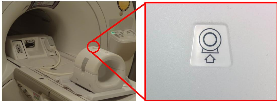
4. Συνδέστε το βύσμα του πηνίου στην κατάλληλη θύρα εκπομπής του συστήματος. (Ανατρέξτε στο εγχειρίδιο χρήσης του συστήματος για τη θέση της θύρας TR) Γυρίστε το άκρο του βύσματος της θύρας P ώστε να εμφανίζει τη θέση ΚΛΕΙΔΩΜΕΝΟ, βλ. εικόνα δεξιά.
