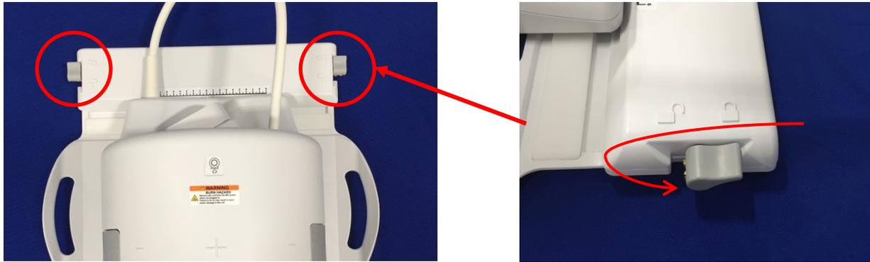
5. Asegúrese de que la posición izquierda-derecha de la bobina está en el centro del soporte. Si hace falta ajustarla, gire el mando del soporte de la bobina para desbloquear la bobina y deslizarla hasta la posición deseada.
