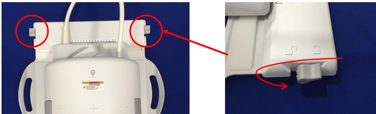
7. Una vez que la bobina esté en la posición deseada, vuelva a girar el mando a la posición de bloqueo para fijar la bobina en su sitio.
