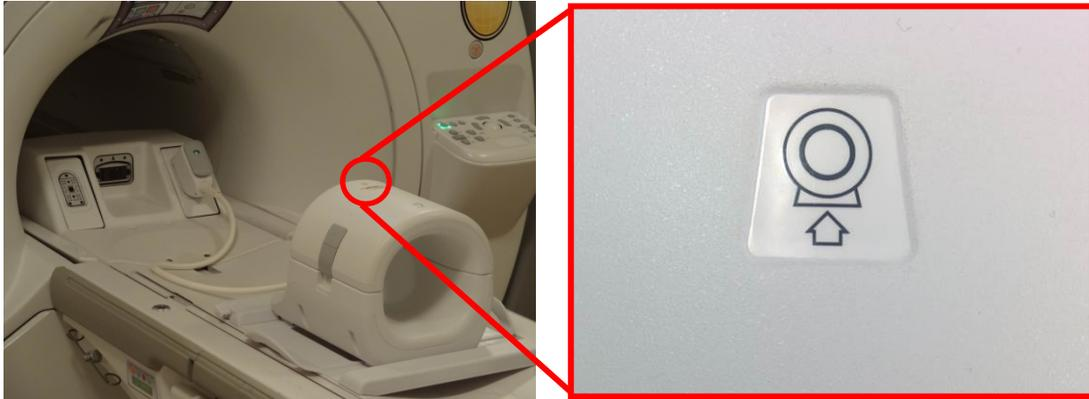
4. Conecte el conector de la bobina al puerto de transmisión correcto del sistema. (Consulte el manual del usuario del sistema para conocer la ubicación del puerto de T/R). Dele la vuelta al extremo del conector del puerto P de modo que se vea la posición de BLOQUEO; fíjese en la ilustración de la derecha.
