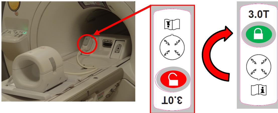
6. Asegúrese de que la posición izquierda-derecha de la bobina está en el centro del soporte. Si hace falta ajustarla, gire el mando del soporte de la bobina para desbloquear la bobina y deslizarla hasta la posición deseada.
