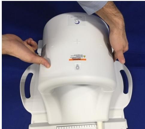
4. Une fois la moitié supérieure complètement fermée, rabattez les languettes de fixation vers le bas des deux côtés, contre la surface de l'antenne, pour engager entièrement les fixations mécaniques. Si les fixations ne sont pas complètement engagées, l'antenne peut s'ouvrir pendant l'examen, occasionnant une perte totale de connexion entre les moitiés d'antenne. Le résultat se traduit par une qualité d'image médiocre ou une détérioration de l'antenne.
