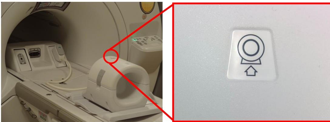
5. Raccordez le connecteur de l'antenne au port d'émission approprié du système. (Consultez le manuel d'utilisation du système pour l'emplacement du port TR) Tournez l'extrémité du connecteur du port P de sorte que la position **VERROUILLÉ** soit visible, comme illustré sur l'image de droite.
