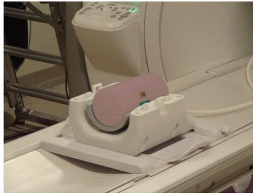
10. Remettez en place la moitié supérieure de l'antenne. **Vérifiez que les deux moitiés sont entièrement fermées et que les languettes de fixation sont rabattues vers l'intérieur.**
