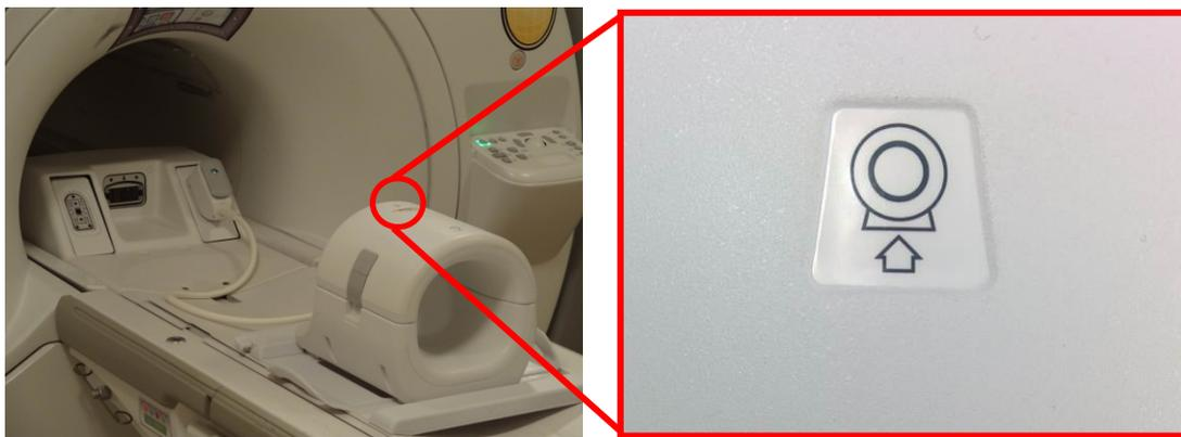
5. Hubungkan konektor gelung ke Port Transmit yang sesuai pada sistem. (Lihat panduan pengguna sistem untuk Lokasi Port TR) Putar ujung konektor P-Port sedemikian rupa sehingga menunjukkan posisi TERKUNCI. Lihat gambar di sebelah kanan.
