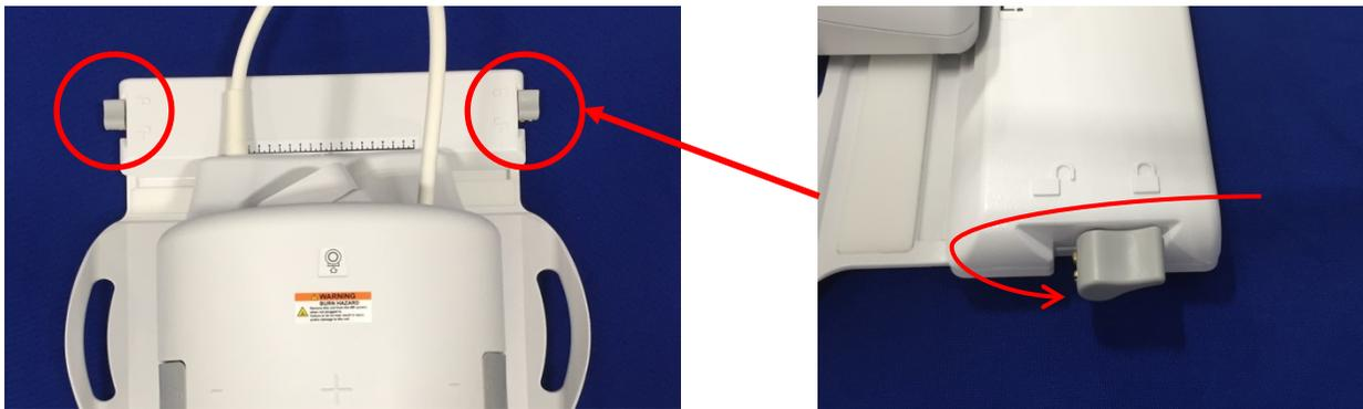
6. Setelah gelang berada pada posisi yang diinginkan, putar tombol kembali ke posisi kunci untuk mengencangkan gelang pada tempatnya.
