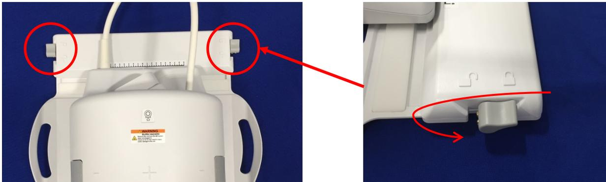
7. Setelah gelang berada pada posisi yang diinginkan, putar tombol kembali ke posisi kunci untuk mengencangkan gelang pada tempatnya.
