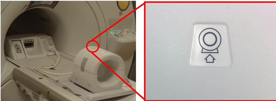
5. Collegare il connettore della bobina alla porta di trasmissione appropriata del sistema (vedere il manuale dell'utente per la posizione della porta di TR). Ruotare l'estremità del connettore della porta P in posizione BLOCCATA; vedere l'immagine a destra.
