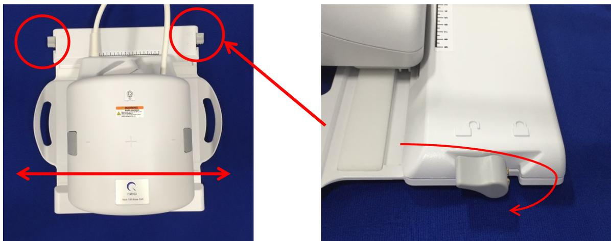
8. Separare la bobina anteriore tirando entrambe le chiusure a scatto simultaneamente fino a staccare completamente le due metà.
