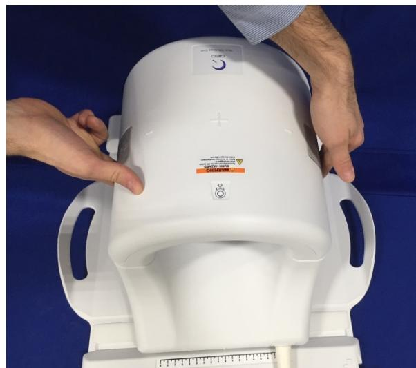
4. После надлежащей установки верхней части катушки вдавите защелки с обеих сторон в направлении к поверхности катушки, чтобы обеспечить надежное механическое соединение. Если защелки полностью не закрыты, катушка может отсоединиться в процессе сканирования и привести к полной или частичной потере соединения между половинками катушки, результатом которого может стать низкое качество получаемого изображения или повреждение катушки.
