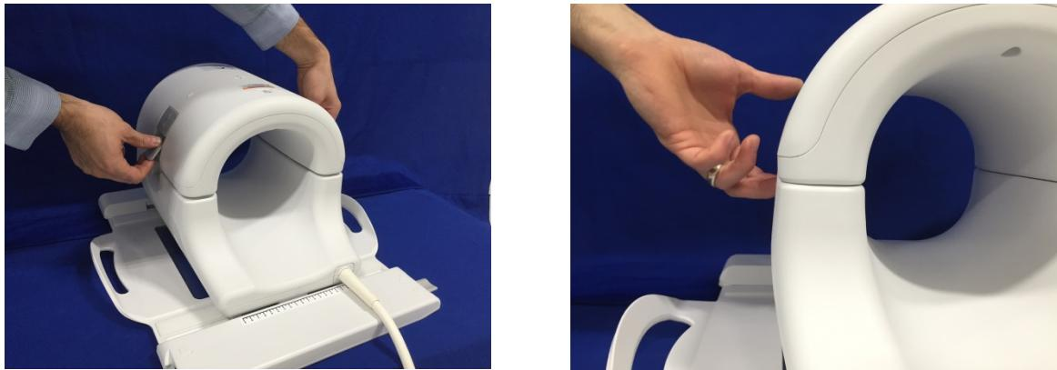
9. Поместите компоненты Катушка 18ch T/R для проведения МРТ колена — нижняя накладка, 0,5 дюйма (5561409-8) и Большой цилиндрический унифицированный фантом, SiOil (5342679-2) на катушку, как показано ниже.
