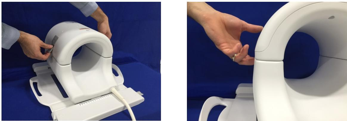
9. Aşağıda gösterilen şekilde, 18ch T/R Diz Koili Alt Ped, 0,5 inç (5561409-8) ve Büyük Silindirik Birleşik Fantom, SiOil'i (5342679-2) koilin üzerine yerleştirin.
