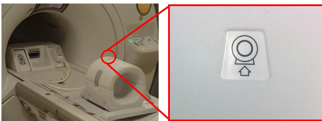
5. Koil konektörünü sistemin uygun Verici Portuna takın. (TR Port konumu için sistem kullanıcı kılavuzuna bakın) P-Port konektörün uç kısmını KİLİTLİ konumu gösterecek şekilde döndürün, aşağıdaki resme bakın.
