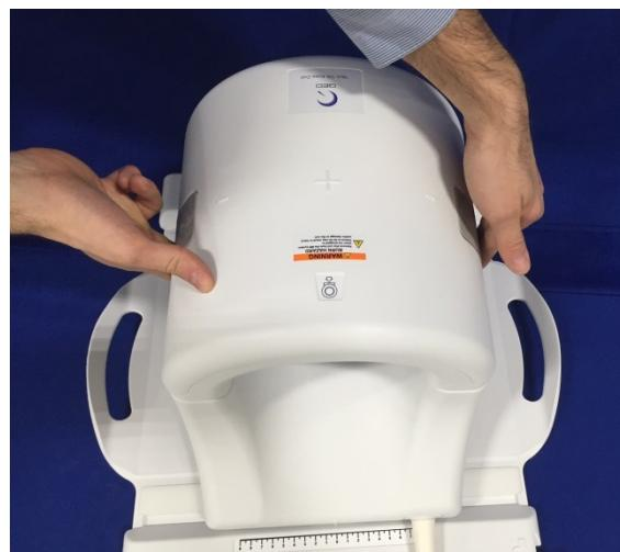
4. Öndeki yarım tamamen kapatıldığında, mekanik mandalları tamamen takmak için mandallarına koilin yüzeyine doğru her iki taraftan bastırın. Mandalların tamamen takılmaması halinde, koil tarama işlemi sırasında çıkabilir ve koilin iki yarım parçası arasında tamamen bağlantı kaybına
