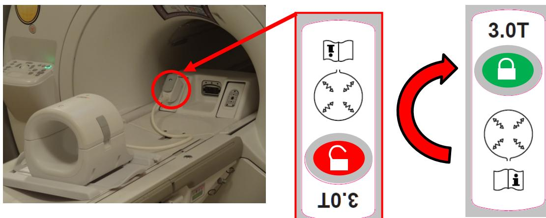
5. Koilin Sol-Sağ konumunun çerçevesinin ortasında olduğundan emin olun. Ayar gerekmese halinde, koilin kilidini açmak ve koili istenen konuma kaydırma için koil çerçevesindeki düğmeyi çevirin.
