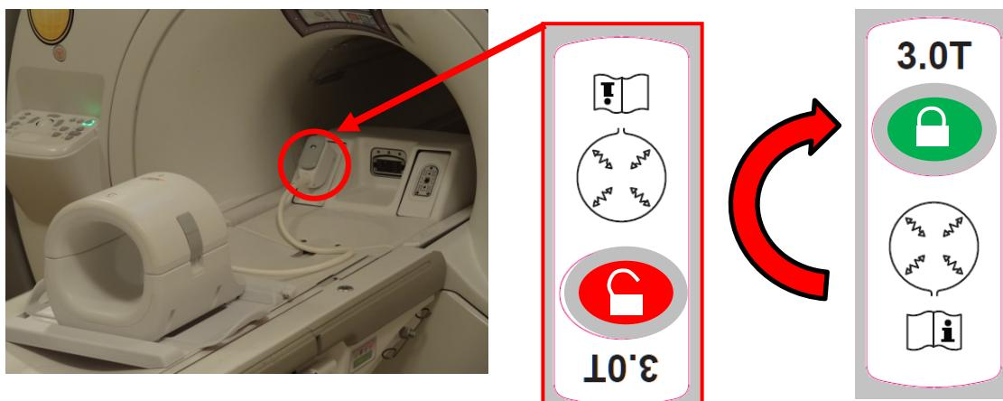
6. Koilin Sol-Sağ konumunun çerçevesinin ortasında olduğundan emin olun. Ayar gerekmese halinde, koilin kilidini açmak ve koili istenen konuma kaydırma için koil çerçevesindeki düğmeyi çevirin.
