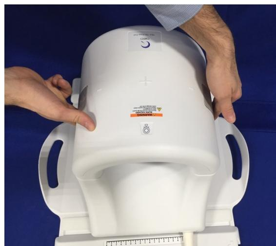
4. Після того як передня половина буде повністю закрита, натисніть застібки-фіксатори донизу з обох боків у напрямку поверхні котушки, щоб механічні фіксатори повністю з'єдналися. Якщо застібки не будуть повністю зафіксовані, котушка може роз'єднатися під час сканування, зв'язок між половинами котушки буде повністю або частково втрачено, що спричинить погрішення якості зображення або пошкодження котушки.
