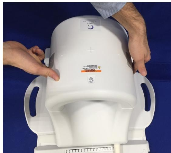
4. Sau khi nửa trước được đóng hoàn toàn, hãy đẩy các nắp lật chốt xuống ở cả hai bên tựa lên bề mặt cuộn cảm nhằm gài chốt hoàn toàn các nắp lật cơ học. Trong trường hợp các nắp lật không được gài chốt hoàn toàn, cuộn cảm có thể tuột ra trong quá trình
