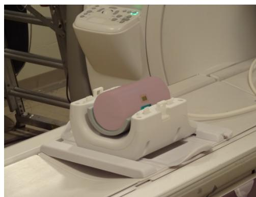
10. Gắn lại nửa Cuộn cảm phía trước. **Đảm bảo hai nửa đã được đóng kín hoàn toàn và các nắp lật chốt đã được đẩy vào.**
