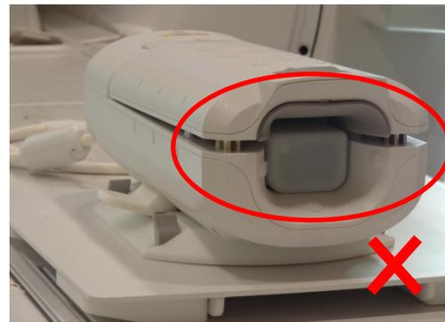
12. Vuelva a registrar la posición de la bobina en la posición de referencia más central que se muestra en la ilustración siguiente y desplace la bobina hacia el isocentro.
