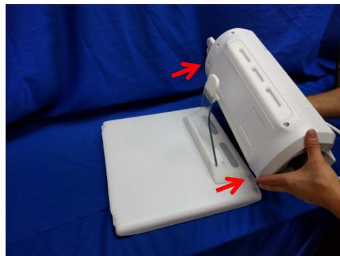
Installez ensuite la base voulue en alignant et en verrouillant l'antenne dans la base, comme indiqué ci-dessous.
