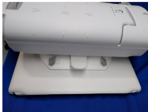
8. Ouvrez l'antenne en faisant glisser le loquet vers l'avant et en soulevant la moitié antérieure vers le haut.
