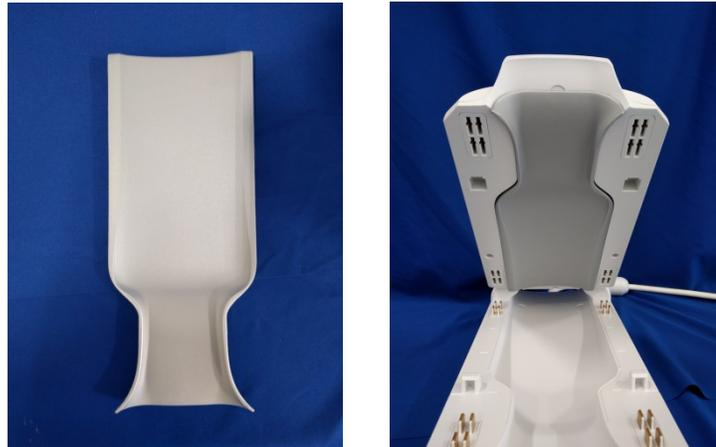
10. Placez le fantôme cubique unifié (5342681) dans l'antenne comme indiqué ci-dessous. **Vérifiez que le bord inférieur du fantôme est aligné avec les marquages FOV sur l'antenne.**
