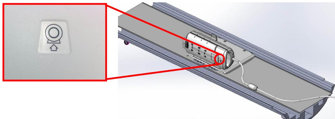
5. 코일 커넥터를 시스템의 적절한 전송 포트에 연결하십시오. (TR 포트 위치는 시스템 사용자 설명서를 참조하십시오.) P 포트 커넥터의 끝을 돌려서 '잠김' 위치가 표시되도록 하십시오. 오른쪽 그림을 참조하십시오.
