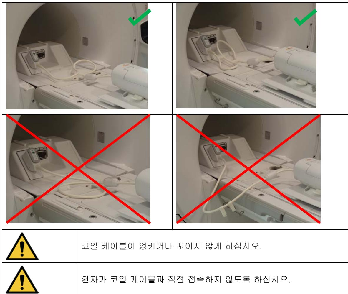
5. 코일 커넥터를 시스템의 적절한 전송 포트에 연결하십시오. (TR 포트 위치는 시스템 사용자 설명서를 참조하십시오.) P 포트 커넥터의 끝을 돌려서 '잠김' 위치가 표시되도록 하십시오. 오른쪽 그림을 참조하십시오.
