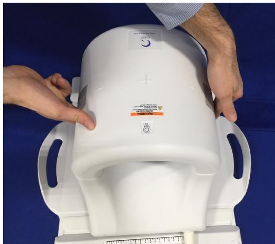
4. Nachdem die vordere Hälfte vollständig geschlossen wurde, schieben Sie die Riegellaschen auf beiden Seiten nach unten gegen die Spuloberfläche, um die mechanischen Riegel vollständig einrasten zu lassen. Wenn die Riegel nicht vollständig eingerastet sind, kann sich die Spule während der Aufnahme lösen und zum Verlust der Verbindung oder zu einer unterbrochenen Verbindung zwischen den Spulenhälften führen und so die Bildqualität vermindern oder die Spule beschädigen.
