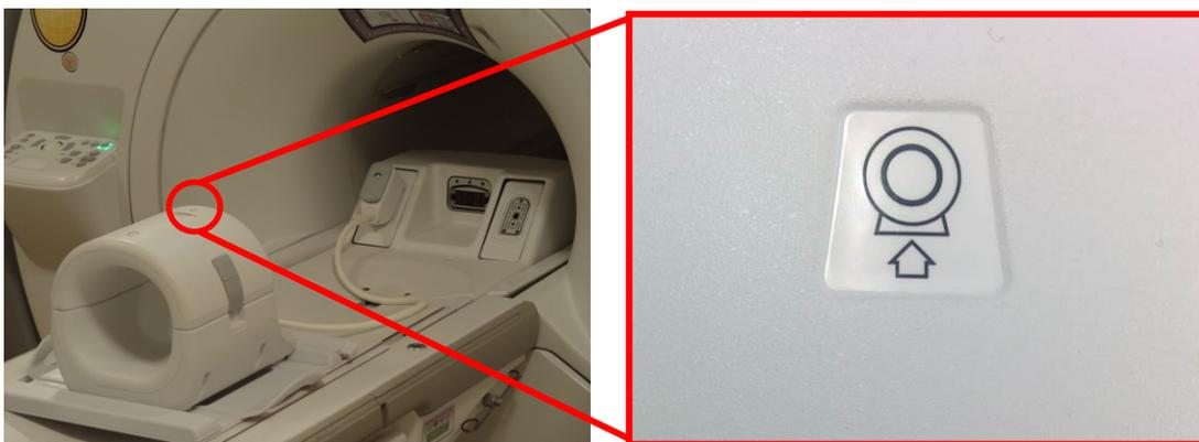
4. Verbinden Sie den Spulenanschluss mit dem entsprechenden Sende-Port des Systems (Siehe Bedienungsanleitung des Systems zur Lage des TR-Ports). Drehen Sie das Ende des P-Port-Anschlusses so herum, dass es die Position VERRIEGELT zeigt, wie in der Abbildung rechts dargestellt.
