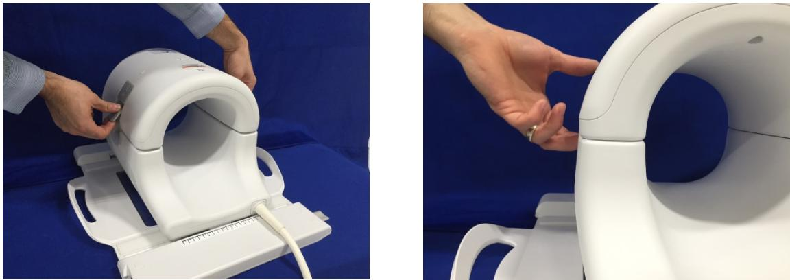
9. Τοποθετήστε το πηνίο γόνατος T/R - Κάτω μαξιλαράκι, 0,25" (5561409-9) ή το πηνίο γόνατος T/R - Κάτω μαξιλαράκι, 0,5" (5561409-8) ή το πηνίο γόνατος T/R - Κάτω μαξιλαράκι, 0,75" (5561409-16) και το μεγάλο κυλινδρικό ενοποιημένο ομοίωμα (5342679) πάνω στο πηνίο όπως απεικονίζεται παρακάτω.
