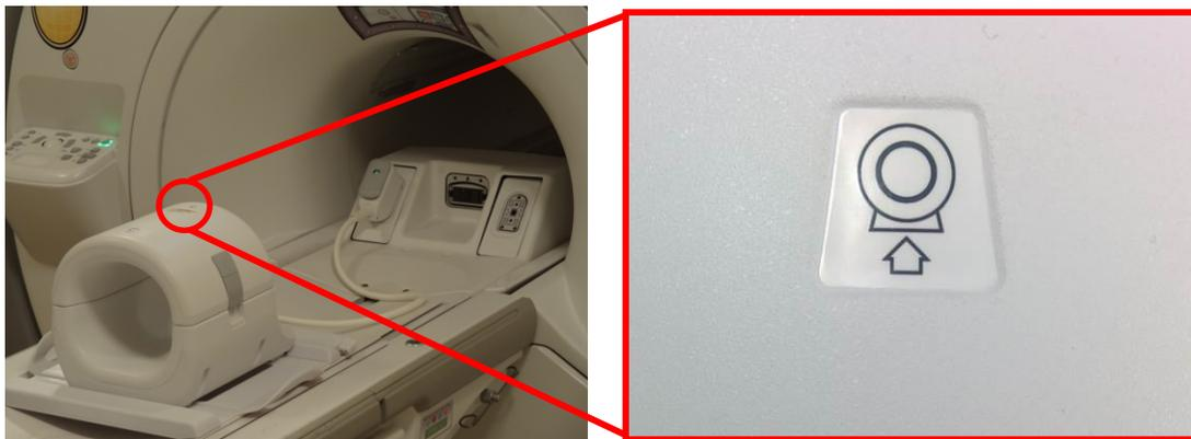
5. Conecte el conector de la bobina al puerto de transmisión correcto del sistema. (Consulte el manual del usuario del sistema para conocer la ubicación del puerto de T/R). Dele la vuelta al extremo del conector del puerto P de modo que se vea la posición de BLOQUEO; fíjese en la ilustración de la derecha.
