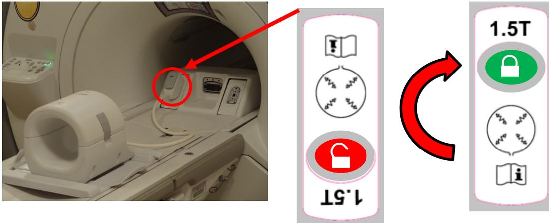
5. Asegúrese de que la posición izquierda-derecha de la bobina está en el centro del soporte. Si hace falta ajustarla, gire el mando del soporte de la bobina para desbloquear la bobina y deslizarla hasta la posición deseada.
