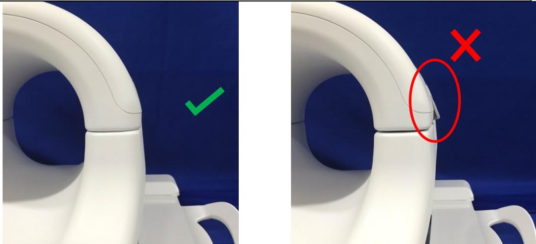
11. Registre la posición de la bobina teniendo en cuenta las marcas que se muestran en la ilustración siguiente y desplace la bobina hacia el interior del túnel.
