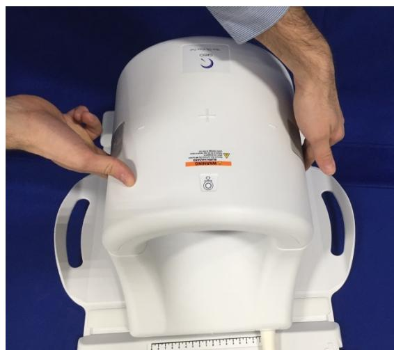
4. Nakon što prednju polovicu potpuno zatvorite, gurnite zasunske prijeklope s obje strane uz stijenku zavojnice kako bi se potpuno prikopčali mehanički zasuni. U slučaju da zasuni nisu potpuno prikopčani, zavojnica se može odvojiti tijekom skeniranja te uzrokovati potpuni gubitak povezanosti ili isprekidani kontakt polovica zavojnice, što će rezultirati lošom kvalitetom slike ili oštećenjem zavojnice.
