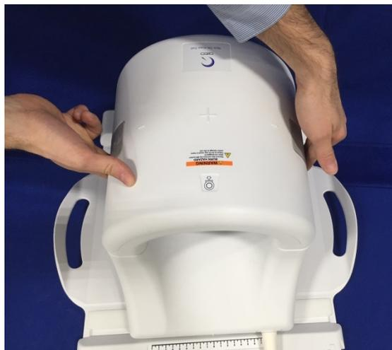
4. Una volta che la metà anteriore è completamente chiusa, spingere le chiusure a scatto verso il basso su entrambi i lati contro la superficie della bobina per innestare completamente le chiusure meccaniche. Nel caso in cui le chiusure non siano perfettamente innestate, la bobina potrebbe disinnestarsi durante la scansione e causare la perdita totale del collegamento o un
