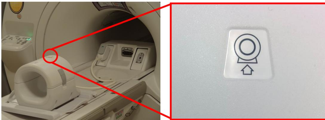
5. Acople o conector da bobina na Porta de Transmissão apropriada do sistema. (Consulte o manual do usuário do sistema para ver a localização da porta de TR) Gire a extremidade do conector Porta P, de forma que mostre a posição TRAVADO. Veja a imagem à direita.
