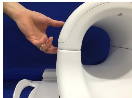
9. Поместите компоненты Катушка T/R для проведения МРТ колена, нижняя накладка, 0,25 дюйма (5561409-9), Катушка T/R для проведения МРТ колена, нижняя накладка, 0,5 дюйма (5561409-8) или Катушка T/R для проведения МРТ колена, нижняя накладка, 0,75 дюйма (5561409-16) и Большой цилиндрический унифицированный фантом (5342679) на катушку, как показано ниже.
