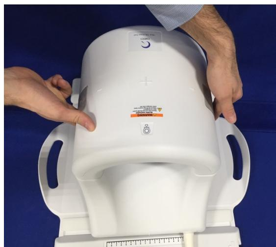
4. Sau khi nửa trước được đóng hoàn toàn, hãy đẩy các nắp lật chốt xuống ở cả hai bên tựa lén bề mặt cuộn cảm nhằm gài chốt hoàn toàn các nắp lật cơ học. Trong trường hợp các nắp lật không được gài chốt hoàn toàn, cuộn cảm có thể tuột ra trong quá trình chụp và gây mất kết nối hoàn toàn hoặc gián đoạn giữa các nửa cuộn cảm, dẫn đến chất lượng ảnh kém hoặc hư hỏng cuộn cảm.
