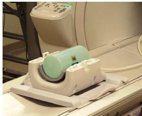
10. Gắn lại nửa Cuộn cảm phía trước. **Đảm bảo hai nửa đã được đóng kín hoàn toàn và các nắp lật chốt đã được đẩy vào.**
