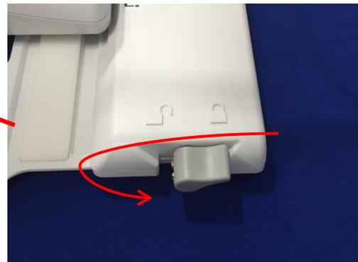
7. Una volta che la bobina si trova nella posizione desiderata, ruotare nuovamente la manopola per bloccarla e fissare la bobina in posizione.
