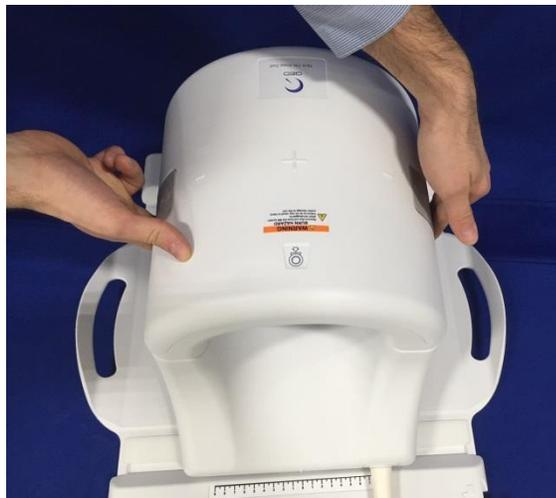
4. Una volta che la metà anteriore è completamente chiusa, spingere le chiusure a scatto su entrambi i lati verso la superficie della bobina per innestare completamente le chiusure meccaniche. Nel caso in cui le chiusure non siano perfettamente innestate, la bobina potrebbe scollegarsi durante la scansione e causare la perdita totale del collegamento o un collegamento intermittente tra le due metà della bobina, con conseguente scarsa qualità delle immagini o danni alla bobina.
