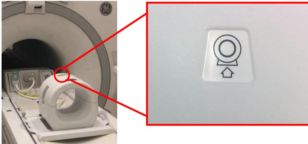
4. Collegare i connettori della bobina alle porte del sistema appropriate. (vedere il manuale dell'utente del sistema per identificare la posizione delle porte). Ruotare l'estremità del connettore della porta P in posizione di BLOCCO (vedere l'immagine a destra).
