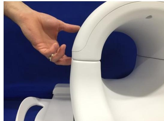
9. Τοποθετήστε το πηνίο γόνατος QED T/R - Κάτω μαξιλαράκι, 0,5" (5561409-8) και το μεγάλο κυλινδρικό ενοποιημένο ομοίωμα, SiOil (5342679-2) πάνω στο πηνίο όπως απεικονίζεται παρακάτω.
