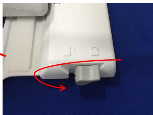
7. Une fois l'antenne positionnée correctement, verrouillez-la en place en tournant de nouveau la molette.
