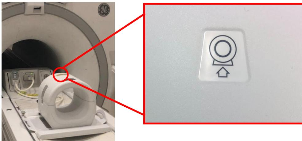
4. Encaixe os conectores da bobina nas portas adequadas do sistema. (Consulte o manual do usuário do sistema para ver a localização das portas) Gire a extremidade do conector P-Port, de forma que mostre a posição TRAVADO. Veja a imagem à direita.
