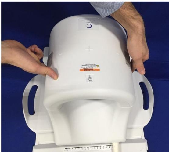
4. Depois que a metade anterior estiver completamente fechada, empurre as presilhas de travamento para baixo, nos dois lados, contra a superfície da bobina, para engatar completamente as travas mecânicas. Caso as travas não estejam totalmente engatadas, a bobina pode se desengatar durante o escaneamento e causar perda total de conexão ou conexão intermitente entre as metades de bobina, o que resultará em imagem de má qualidade ou danos à bobina.
