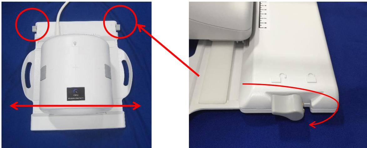
7. Separe a bobina anterior puxando as duas presilhas de travamento simultaneamente, até que as duas metades estejam totalmente desengatadas.
