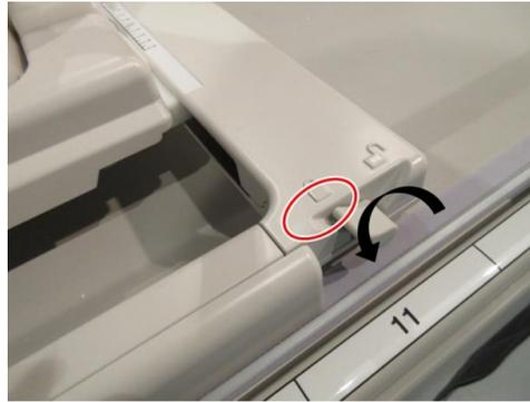
(5) Ajuste la inclinación de la bobina al ángulo deseado (0° o 15°).
