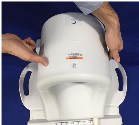
4. Nachdem die vordere Hälfte vollständig geschlossen wurde, schieben Sie die Riegellaschen auf beiden Seiten nach unten gegen die Spulenoberfläche, um die mechanischen Riegel vollständig einrasten zu lassen. Wenn die Riegel nicht vollständig eingerastet sind, kann sich die Spule
