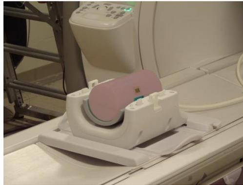
10. Setzen Sie die vordere Spulenhälfte wieder ein. **Achten Sie darauf, dass die beiden Hälften vollständig geschlossen und die Riegellaschen eingedrückt sind.**
