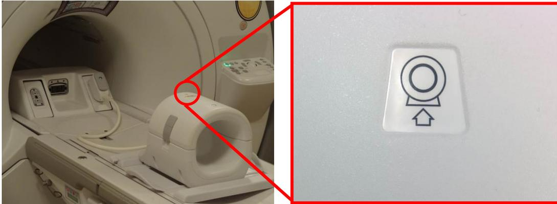
4. Collegare il connettore della bobina alla porta di trasmissione appropriata del sistema (vedere il manuale dell'utente del sistema per la posizione della porta di trasmissione/ricezione). Ruotare l'estremità del connettore della porta P in posizione di BLOCCO come mostrato nell'immagine a destra.
