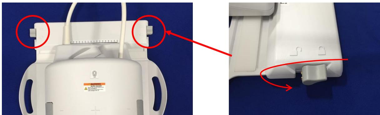
7. Una volta che la bobina si trova nella posizione desiderata, ruotare nuovamente la manopola per bloccarla e fissare la bobina in posizione.
