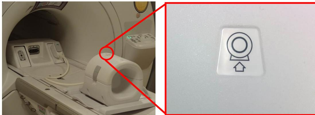
4. Шарғының жалғағышын жүйенің тиісті Жіберу портына жалғаңыз. (TR порттардың орналасқан жері туралы ақпаратты жүйені пайдаланушының нұсқаулығынан қараңыз.) Оң жақтағы суретке қарап, P-Port жалғағыштың үшін ҚҰЛЫПТАЛҒАН қалпын көрсететіндей етіп бұрыңыз.
