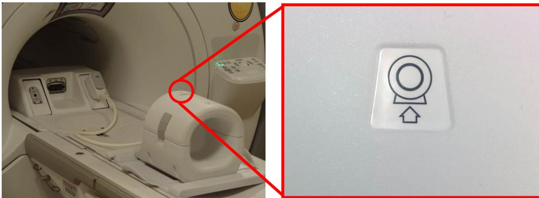
5. Acople o conector da bobina na Porta de Transmissão apropriada do sistema. (Consulte o manual do usuário do sistema para ver a localização da porta de TR) Gire a extremidade do conector Porta P, de modo que mostre a posição TRAVADO. Veja a imagem à direita.
