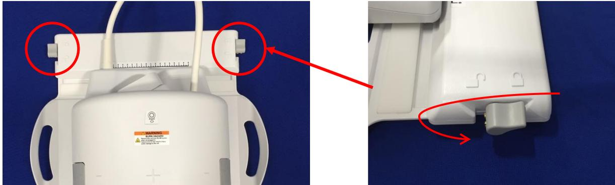
7. Depois que a bobina atingir a posição desejada, gire o botão novamente para a posição travada para travar a bobina em posição.
