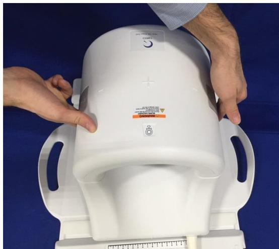
4. Depois que a metade anterior estiver completamente fechada, empurre as presilhas de travamento para baixo, nos dois lados, contra a superfície da bobina, para engatar completamente as travas mecânicas. Caso as travas não estejam totalmente engatadas, a bobina pode se desengatar durante o exame e causar perda total de conexão ou conexão intermitente entre as metades de bobina, o que resultará em imagem de má qualidade ou danos à bobina.
