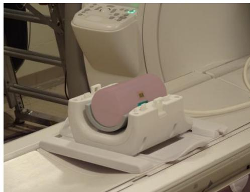
10. Reencaixe a metade anterior da bobina. **Certifique-se de que as duas metades estejam completamente fechadas e que as presilhas de travamento estejam empurradas para dentro.**
